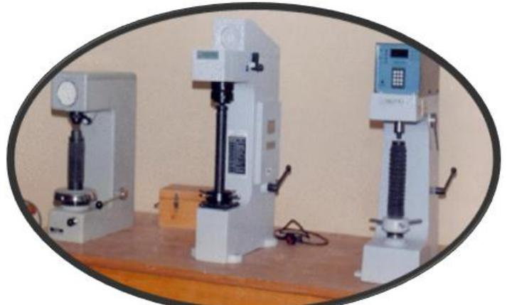
**جهاز اختبار الصلادة**
